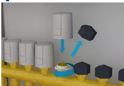
Vissez les bouchons du régulateur, vissez l'adaptateur de vanne, enclenchez l'entraînement de la vanne!
