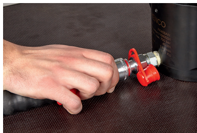
5.2 Weibliche Seite der Hydraulikleitung an die Presskette anschließen
