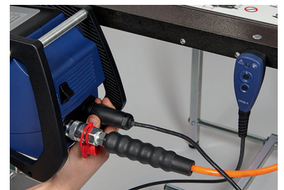
6 Fernbedienung an die Rückseite der Pumpe anschließen (drücken & drehen)
