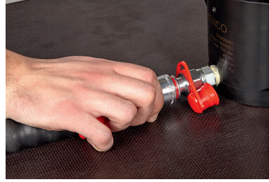
5.2 Raccorder le côté femelle du tuyau hydraulique à la chaîne de sertissage
