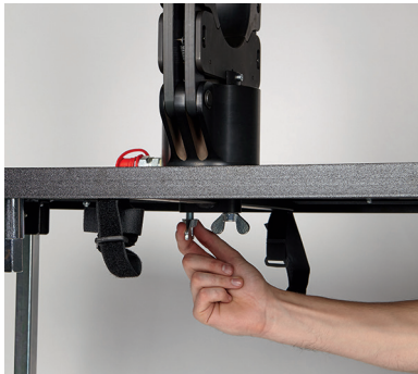
2 Poser la chaîne de sertissage sur la table et la fixer par dessous avec les deux boulons ailés
