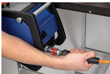
5.1 Raccorder le côté mâle du tuyau hydraulique à l'arrière de la pompe
