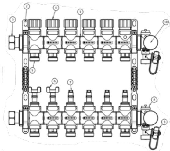
1. Armadura del colector
