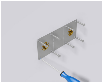
Fixer la platine au mur.
