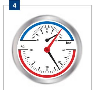
Mettez le distributeur sous pression. Minimum 4 bars, maximum 6 bars (d'après la norme NEN-EN 1264-4).
