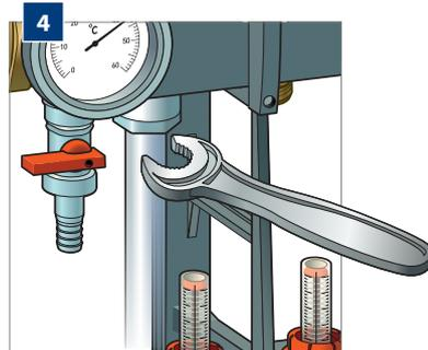
Serrez **le raccord à l'aide de la clé de montage** synthétique livrée.
