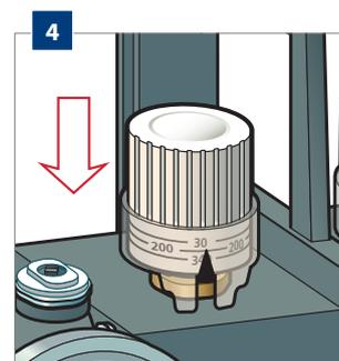
**Replacez la coiffe de verrouillage** par-dessus la roue de manœuvre pour éviter de modifier le réglage.
