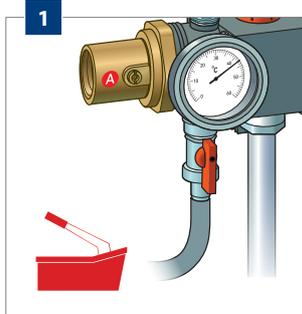
Raccordez la pompe du test au robinet d'apport et de vidange du distributeur d'apport.
