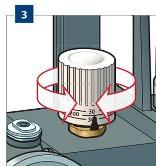
Réglez le flux calculé en tournant la **roue de manœuvre** vers la valeur exacte.
