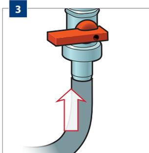
Raccordez les conduites de remplissage et de vidange aux abouts des robinets de remplissage et de vidange sur le distributeur d'apport et de retour.
