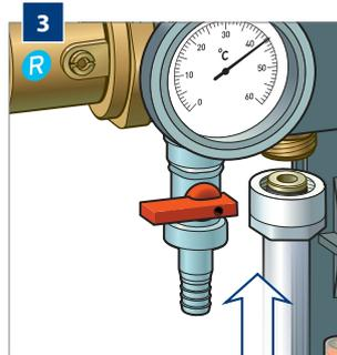
Raccordez **la conduite pour le chauffage par le sol** au **distributeur de retour**.
