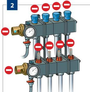
Fermez tous les groupes au moyen des capteurs du flux et des valves thermostatiques.
