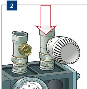
Raccordez la **conduite principale** sur la vanne thermostatique.
