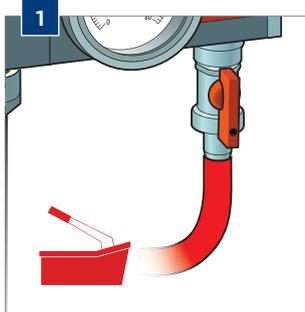
Raccordez la **pompe d'essai** sur le **robinet de remplissage et de vidange** du **distributeur d'arrivée**.
