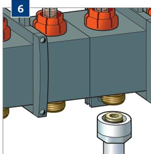
Coupez l'autre extrémité de la conduite à la **bonne longueur** et raccordez-la de la même façon sur le **distributeur d'arrivée**.
