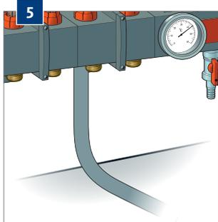
**Posez la conduite.** Évitez de mettre de la tension sur le distributeur en réalisant un coude vertical mais fluide.
