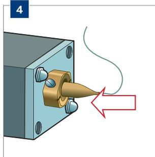
Insérez le **palpeur** dans le **tube immergé**.
