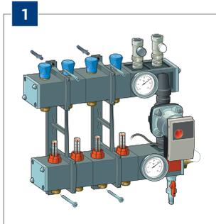
Montez le distributeur au mur avec les **boulons et chevilles** fournis.
