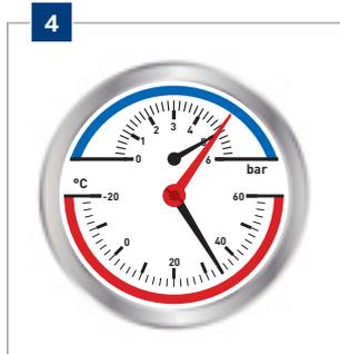
Mettez le distributeur sous **pression**. Minimum 4 bars, maximum 6 bars (selon la norme NEN-EN 1264-4).
