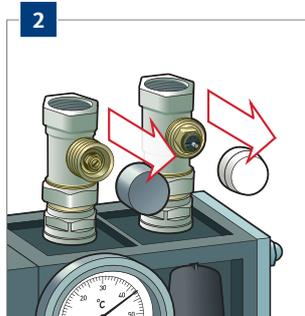
Déposez le **capuchon de protection** des vannes de retour et thermostatique.
