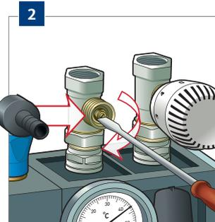
Fermez la **vanne de retour** avec un tournevis et vissez l'**embout de tuyau** fourni sur la **vanne de retour**.
