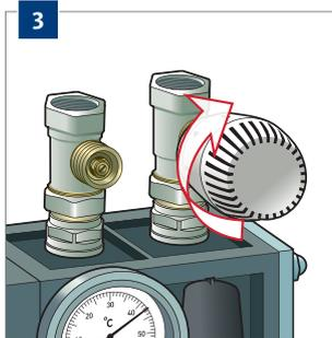
Vissez le **bouton thermostatique** sur 6 et serrez-le à la main sur la **vanne thermostatique**.
