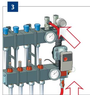
Raccordez la **conduite de remplissage** sur le **robinet de remplissage et de vidange**, et la **conduite de vidange** sur la **vanne de retour**.
