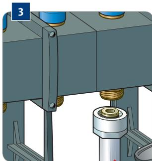
Raccordez la **conduite de chauffage par le sol** sur le distributeur de retour.
