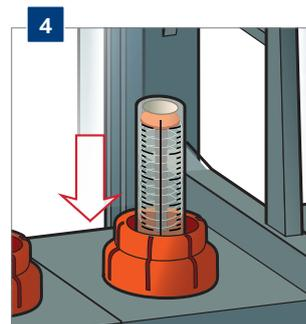
Remontez le **capuchon de verrouillage** sur le **débitmètre** pour éviter de modifier le réglage.
