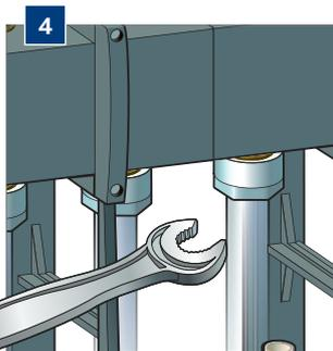
Serrez le **raccord** avec la **clé de montage** en plastique fournie.
