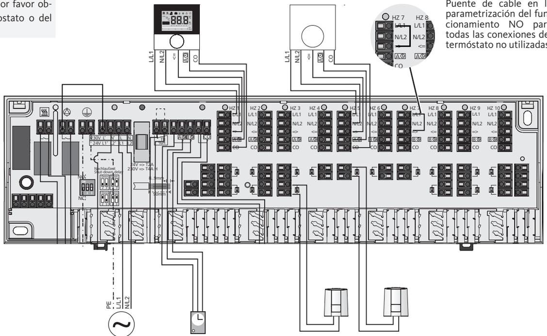
Puente de cable en la parametrización del funcionamiento NO para todas las conexiones del termostato no utilizadas.
