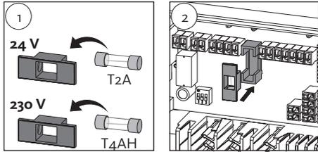
En dependencia del fusible insertado (incluido en el volumen de entrega), el CU-6ZONE puede ser operada en fuentes de tensión de 24 V o de 230 V.
