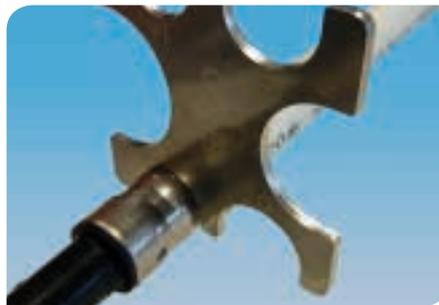
5. Pivotez l'instrument de mesure de 360° autour de l'impression sur le manchon à serrer et veillez à ce qu'ils se raccordent tous deux parfaitement comme indiqué à l'étape 4. En cas d'échec (par exemple, distance trop grande, entrave, etc.), cela signifie que le sertissage du raccord s'est mal déroulé. Si c'est le cas, nous vous recommandons de réaliser un assemblage par sertissage totalement neuf et de contrôler la machine à serrer ainsi que la mâchoire à serrer.
