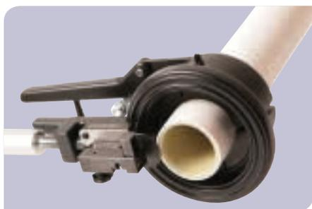
Coupez le tube perpendiculairement à 90° avec le coupe-tube. Le coupe-tube est prévu d'une mâchoire pour que le tube reste à sa position exacte.
