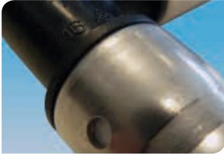
1. Vérifiez le  $\varnothing$  du raccord à serrer.
