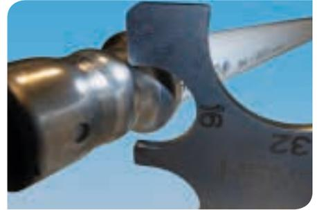
3. Placez l'entaille correspondante de l'instrument de mesure sur l'impression se trouvant sur le manchon à serrer.
