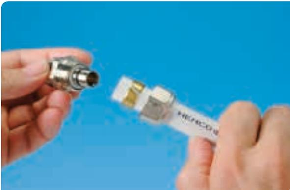
Placez l'adaptateur dans le tube et glissez-le jusque contre la butée. Veillez toujours à ce qu'il y ait un anneau en matière synthétique pour éviter l'électrolyse.
