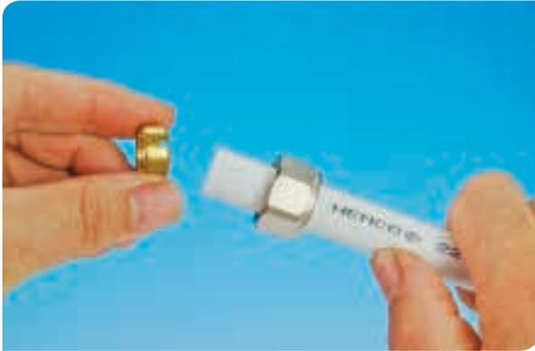
Glissez tout d'abord le raccord écrou en ensuite l'anneau de serrage sur le tube. Pour favoriser le glissement, vous pouvez graisser l'écrou avec de l'huile de silicones. N'utilisez jamais d'huile minérale !
