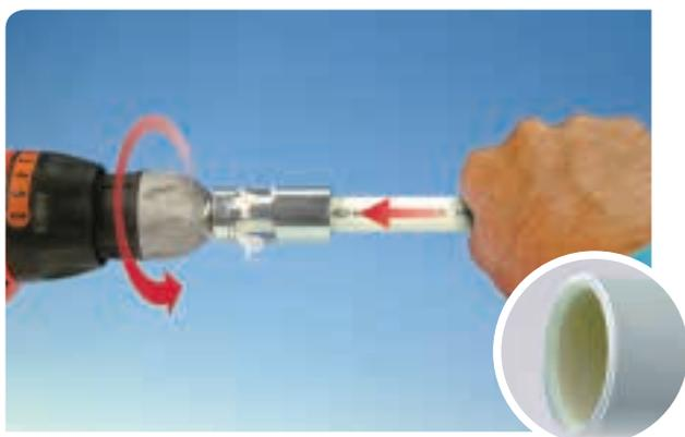
Une fois le tube correctement calibré (centré, biseauté, aplani), le biseautage de l'intérieur et de l'extérieur du tube est totalement visible autour.
