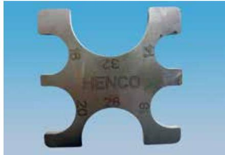
2. Suchen Sie die entsprechenden  $\varnothing$  auf dem Messgerät.
