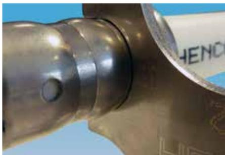
4. Achten Sie darauf, dass das Messgerät und die Druckstelle perfekt aneinander anschließen.
