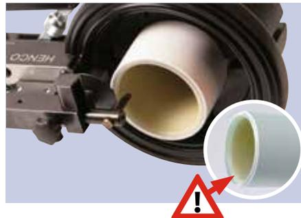
Fasen Sie die Rohrinneenseite an, indem Sie das Anfasgerät gegen die Innenwand des Rohres drücken und damit eine ganze Umdrehung ausführen.
