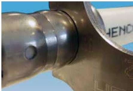
4. Achten Sie darauf, dass das Messgerät und die Druckstelle perfekt aneinander anschließen.
