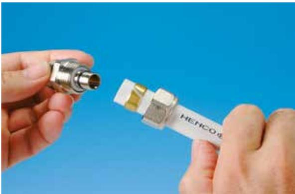
Stecken Sie den Adapter in das Rohr und drücken Sie ihn gegen den Stoßrand. Um Elektrolyse zu vermeiden, sollten Sie sich immer davon vergewissern, dass ein Kunststofftrennring vorhanden ist.
