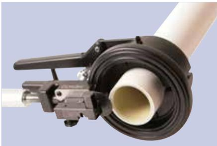
Längen Sie das Rohr mit Hilfe des Rohrschneiders rechtwinklig ab. Der Rohrschneider ist mit einer Klemmschelle ausgerüstet, die das Rohr in der korrekten Position fixiert.
