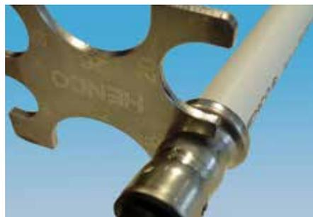
**ACHTUNG!** Das PRESSCHECK Messgerät kommt nur zur Anwendung bei Pressfittings, die mit dem Henco Profil (BE Profil) oder dem TH Profil (bis  $\varnothing 26$ ) hergestellt sind, in Kombination mit einem Henco PVDF oder Messing Pressfitting.
