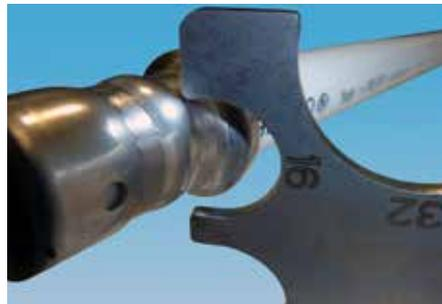
3. Legen Sie die entsprechende Aussparung des Messgerätes auf die Druckstelle, die sich auf der Presshülse befindet.
