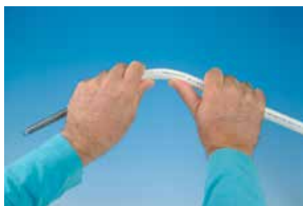
Pliage avec ressort spiral interne
