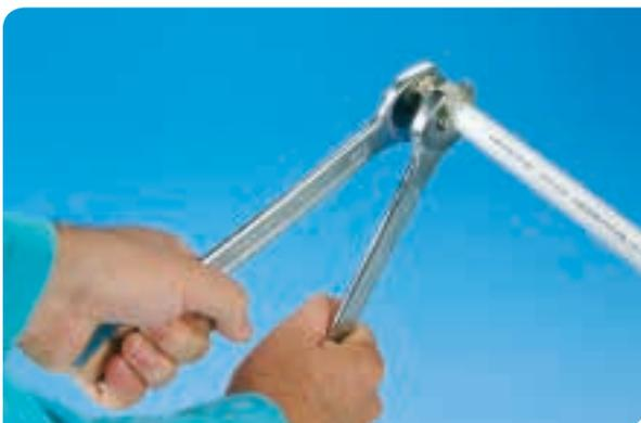
**Vorgeschriebenes Anzugsmoment bei der Herstellung einer Schraubverbindung**
