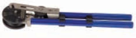
Der Ursprung einer Biegung (L) muss vom Fitting mindestens  $3 \times$  Rohraußendurchmesser entfernt sein.
